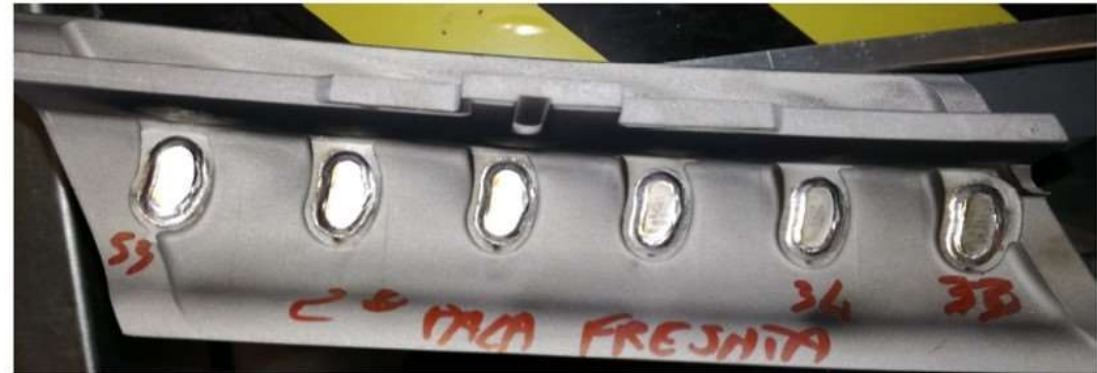
Saldatura e posizionamento centrati e senza tratti con fusione
