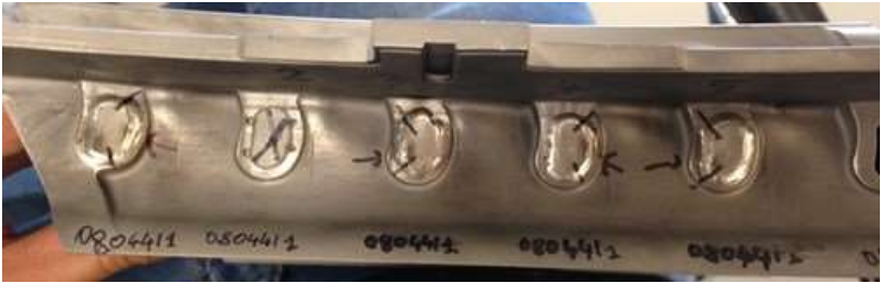
LP: saldatura 4 non presenta difetti -> la rampa di chiusura fissata per le prove successive ad una durata di 1000 ms effettuandola sul lato sinistro del cordone.
