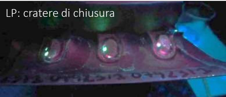
Larghezza del cordone di saldatura variabile da 1 mm a max 3 mm.
