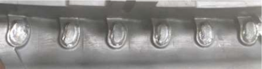
Larghezza del cordone di saldatura variabile da 1 mm a max 3 mm.
