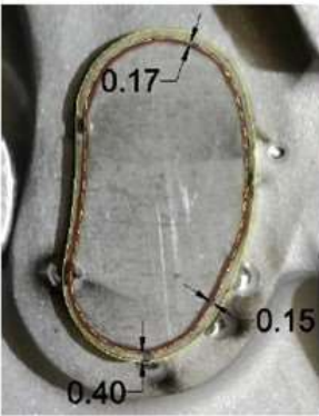
Prove di marcatura con plates puntati
