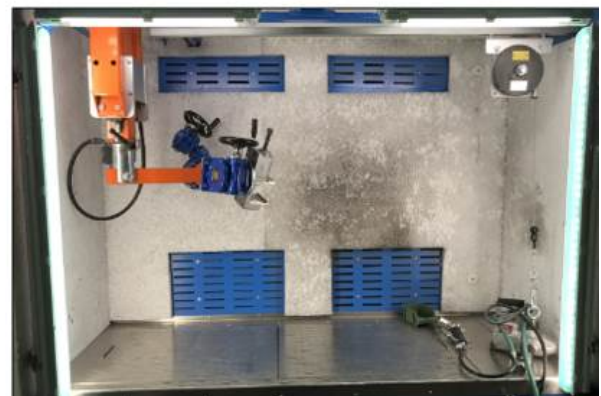
Fig. 7 Soluzione innovativa per le lavorazioni di finitura: manipolatore ergonomico sviluppato con il progetto
