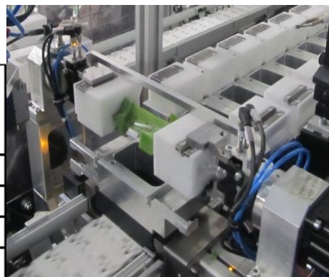
Fig. 2 Vantaggi conseguiti con l'automazione dell'inserimento dei Pt-pin e particolare della macchina sviluppata con il progetto
