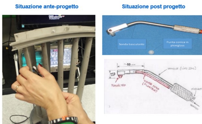
Fig. 3 A sx, Sistema automatizzato per misurare lo spessore delle pareti delle palette di turbina, sviluppato con il progetto. A dx la metodologia di misura classica e il sensore di misura sviluppato per il robot
